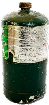
Los cilindros de un solo uso son **peligrosos**. Cuando están "vacíos", los cilindros de un solo uso a menudo aún contienen una pequeña cantidad de gas, lo que representa un peligro para los trabajadores sanitarios debido al riesgo de explosiones y los incendios resultantes. Debido al peligro que implican, cuestan millones de dólares reciclarlos y desecharlos adecuadamente.
